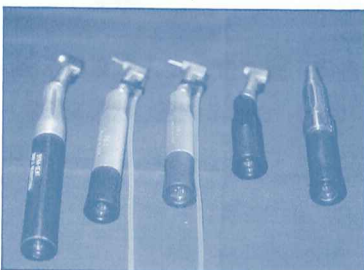
圖41：由左起，280：1減速植牙手機；70：1減速植牙手機；18：1減速植牙手機；1：1植牙手機；最右圖，直手機。
