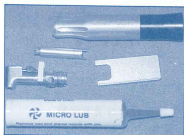
圖76：植牙鑽骨手機需定期拆下來作較徹底的清潔保養。
